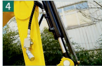
Yağ Silindiri Koruma Kapağı Silindiri dış etkenlere karşı koruyarak dayanıklılığı artırır.
