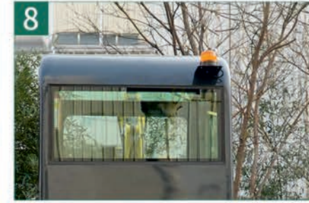
Uyarı Lambaları Operasyon sırasında güvenliği artırmak için uyarı sistemi.
