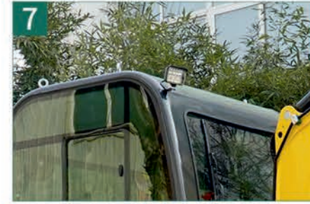
LED Aydınlatma Gece ve düşük ışık koşullarında yüksek görünürlük sağlar.
