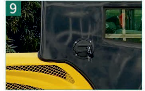
Yağ Doldurma Kapağı Kolay erişim ve hızlı yağ dolumu için optimize edilmiş tasarım.
